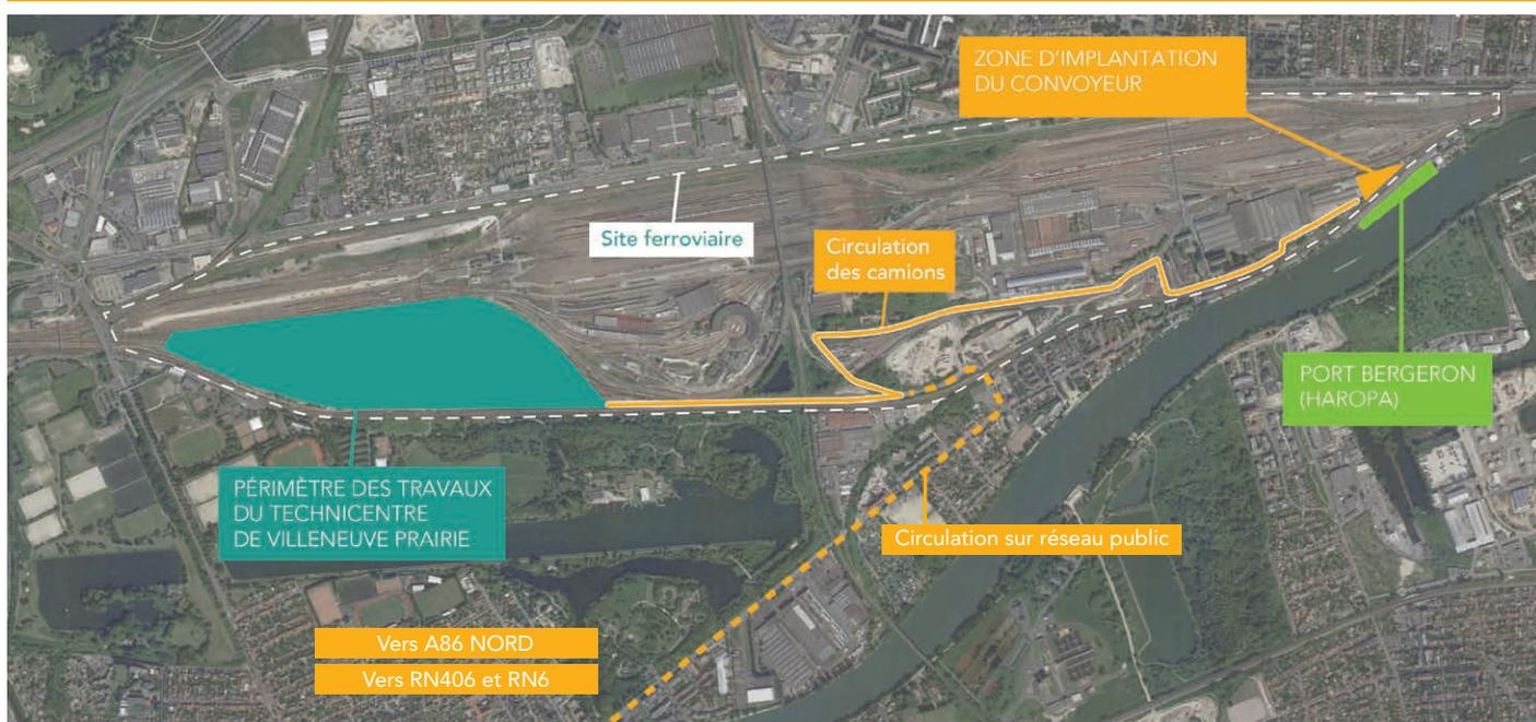
**Les travaux de démolition commencent au technicentre.** Le château d'eau et plusieurs bâtiments utilisés aujourd'hui pour la maintenance des trains vont être détruits, ainsi que certains réseaux enterrés non-conservés pour la suite des opérations. **Le nouvel atelier de 12 600 m<sup>2</sup> prendra leur place pour répondre aux nouvelles exigences d'entretien et de maintenance des trains Regio2N et des RER nouvelle génération.**
